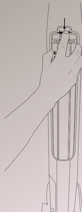
3. Verwijder de accu door op de bovenste inkeping te drukken en hem naar je toe te trekken
