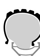
Diagrama 29. Cámara dentro de la llanta
