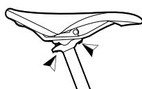
Figura 7. Reggisella con due viti di serraggio
