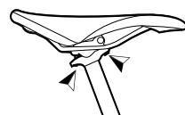
Abb. 7. Sattelstütze mit zwei Klemmschrauben
