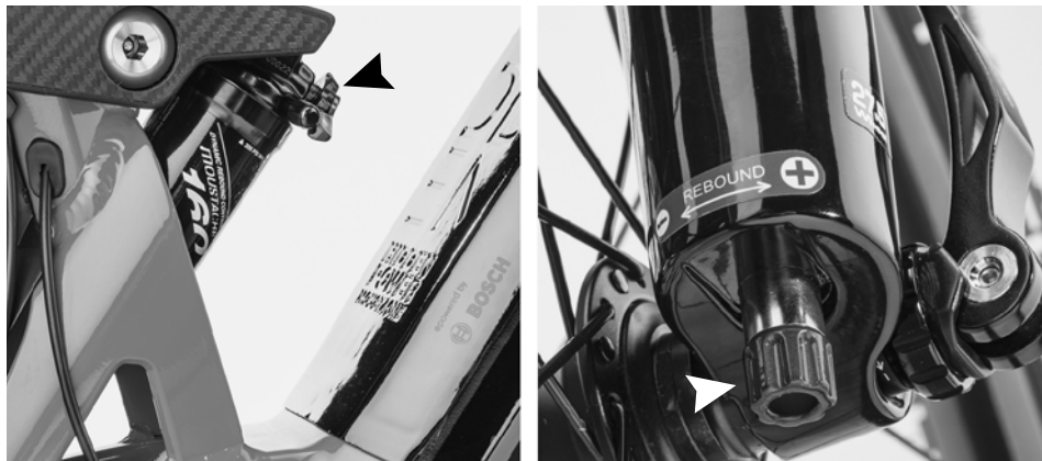
Diagrama 25. Ejemplos de discos de ajuste de rebote: a la izquierda para amortiguador, a la derecha para horquilla.
