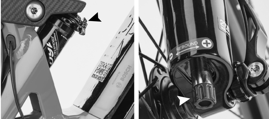
Abb. 25. Beispiel für Drehradchen zur Zugstufeneinstellung: links an einem Dämpfer, rechts an einer Federgabel.
