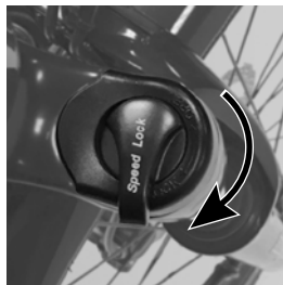
Diagrama 20. Palanca en posición cerrada.
