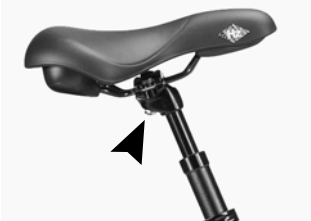
Figure 6. Reggisella con una sola vite di serraggio.
