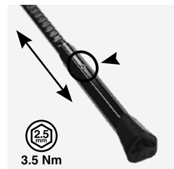
Abb. 32. Einstellen des Pletscher Fahrradständers
