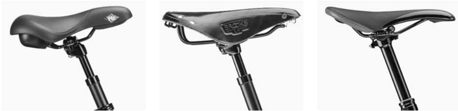
Diagrama 5. Ajuste del ángulo del sillín para una Lundi 26 (izquierda), para uso mixto (centro) y para MTB (derecha).
