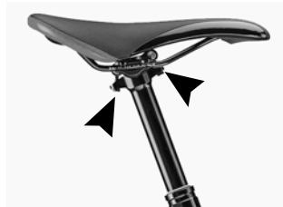
Abb. 7. Sattelstütze mit zwei Klemmschrauben.
