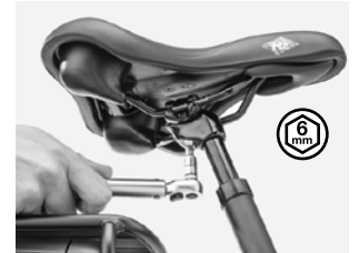
Diagrama 8. Apriete/desapriete del tornillo de bloqueo.
