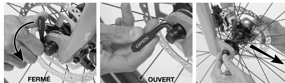
Figure 15. Ouverture de l'axe à blocage rapide.
