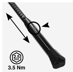
Diagrama 32. Ajuste de la caballete Pletscher.
