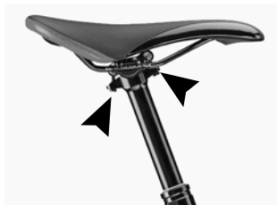
Diagrama 7. Tija de sillín con dos tornillos de bloqueo.
