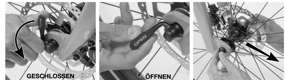
Abb. 15. Öffnen der Schnellspannachse.
