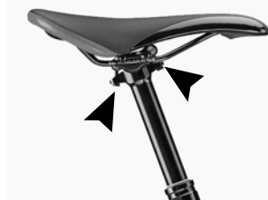
Figure 7. Reggisella con due viti di serraggio.
