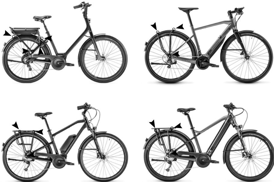
Abb. 35. Die Befestigungspunkte für die unterschiedlichen Gepäckträgern sind mit den schwarzen Pfeilen dargestellt.
