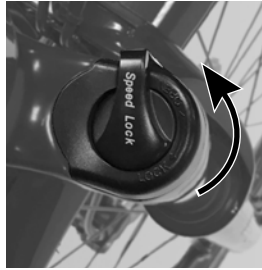
Abb. 19. Hebel in offener Stellung.
