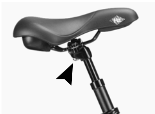
Diagrama 6. Tija de sillín con un tornillo de bloqueo.
