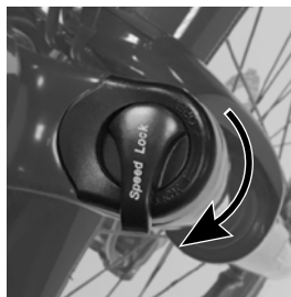
Figura 20. Leva in posizione chiusa.
