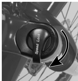
Figure 20. Molette en position fermée.
