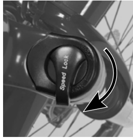
Abb. 20. Hebel in geschlossener Stellung.
