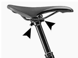
Figure 7. Selle avec deux vis de blocage.
