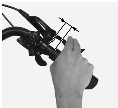
Diagrama 11. Separación entre la maneta de freno y el puño.
