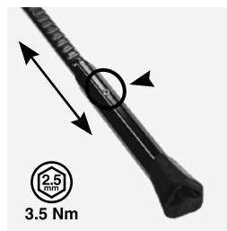
Figure 32. Réglage de la béquille Pletscher
