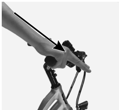
Figure 10. Levier de frein aligné avec l'avant-bras.
