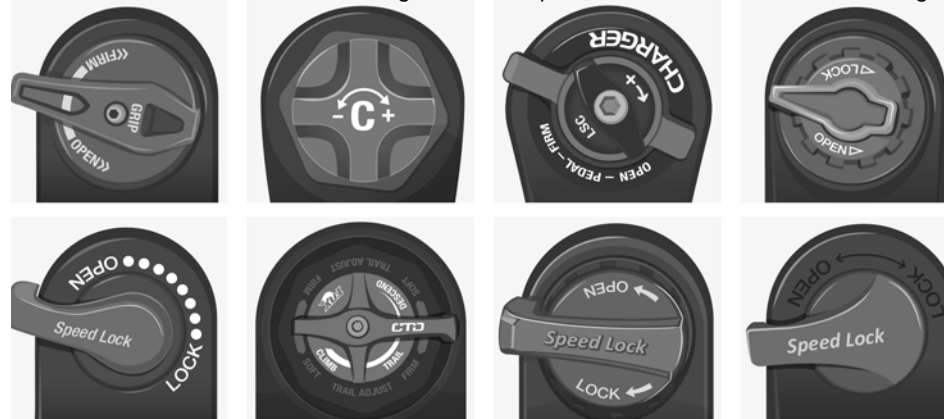
Figure 18. Différents systèmes de blocage de fourche.
