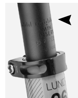
Diagrama 4. Altura máxima en la tija del sillín.
