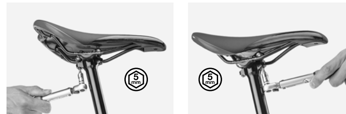
Figure 9. Étapes de serrage/desserage des vis de blocage.
