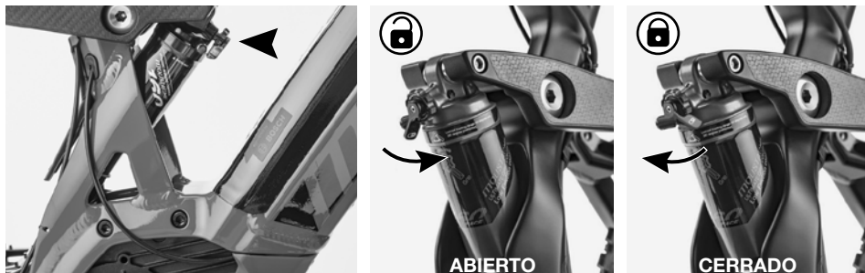
Diagrama 21. Posición abierta y cerrada del amortiguador.
