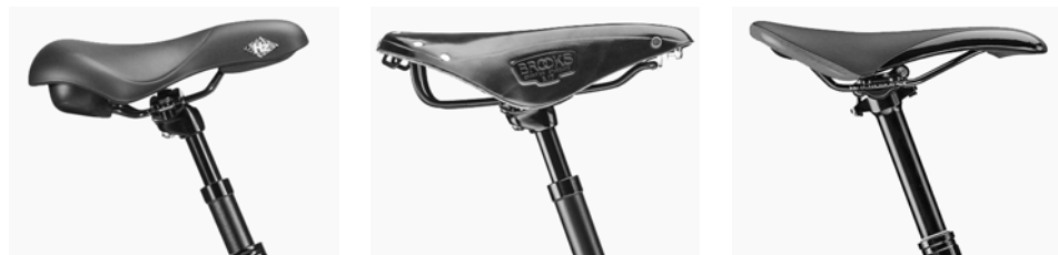
Figure 5. Réglage d'inclinaison de selle pour un Lundi 26 (à gauche), pour un usage mixte (milieu) et un usage VTT (à droite).
