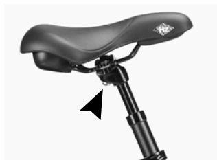
Figure 6. Selle avec une vis de blocage.
