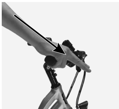
Diagrama 10. Maneta de freno alineada con antebrazos.
