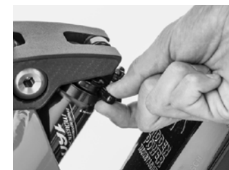
Figura 23. Manipolazione del cappuccio della valvola.
