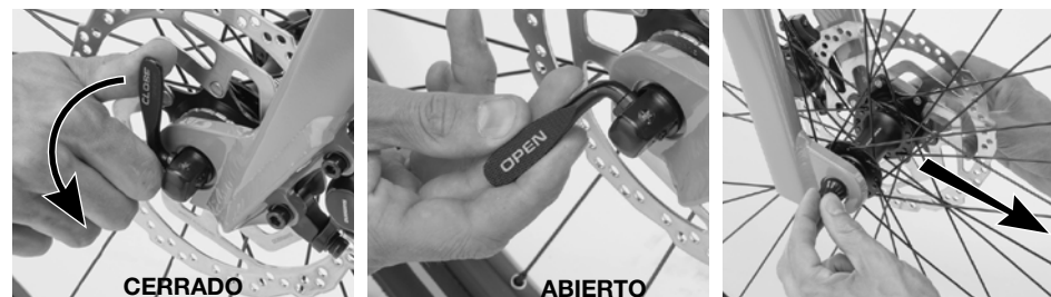
Diagrama 15. Apertura del eje de desenganche rápido.
