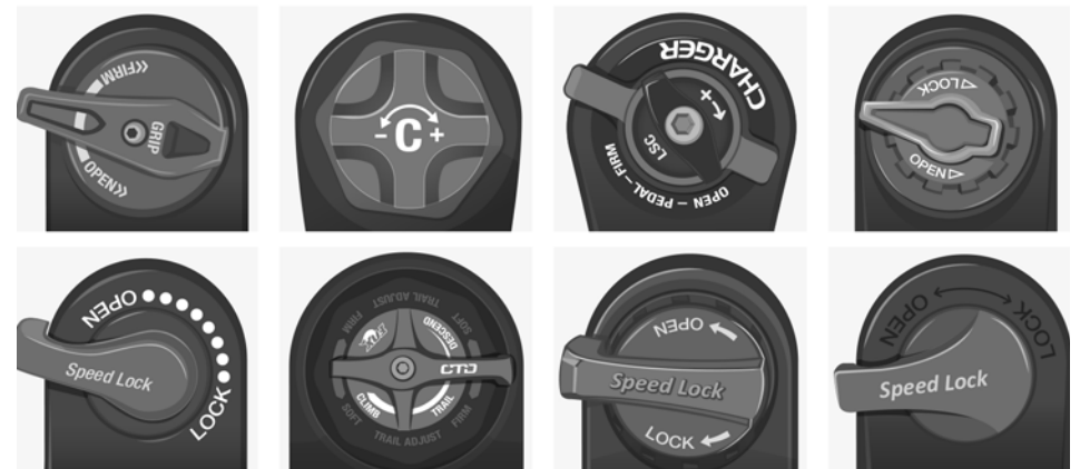
Diagrama 18. Diferentes sistemas de bloqueo de horquillas.
