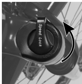
Figura 19. Leva in posizione aperta.
