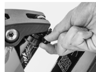
Abb. 23. Entfernen der Ventilkappe.
