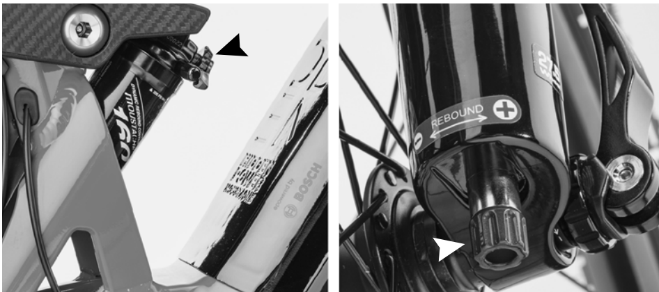
Figure 25. Exemples de molettes de réglage du rebond : à gauche pour un amortisseur, à droite pour une fourche.
