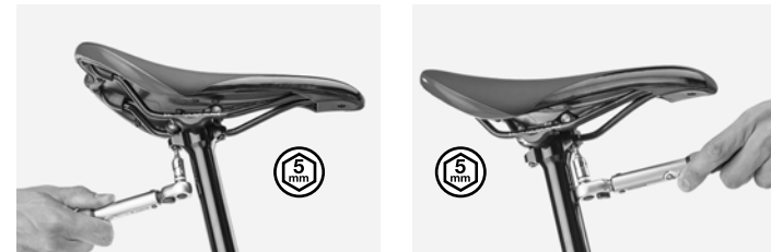
Diagrama 9. Fase de apriete/desapriete de los tornillos de bloqueo.
