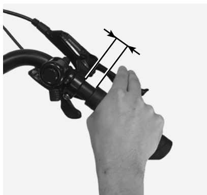
Figura 11. Spazio tra la leva del freno e l'impugnatura.
