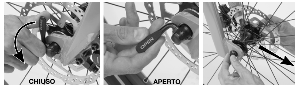
Figura 15. Apertura del perno a sgancio rapido.
