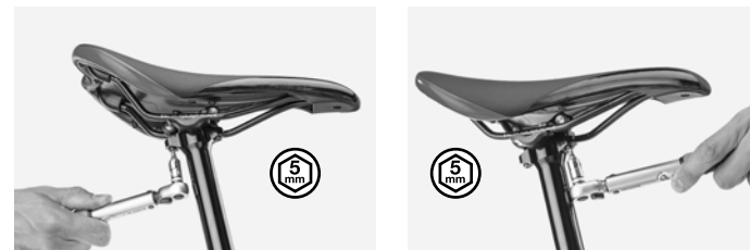
Figura 9. Fase di avvitamento/svitamento della vite di serraggio.
