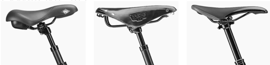
Figura 5. L'impostazione dell'angolo della sella per una Lundi 26 (a sinistra), per uso misto (in mezzo) e per MTB (a destra).
