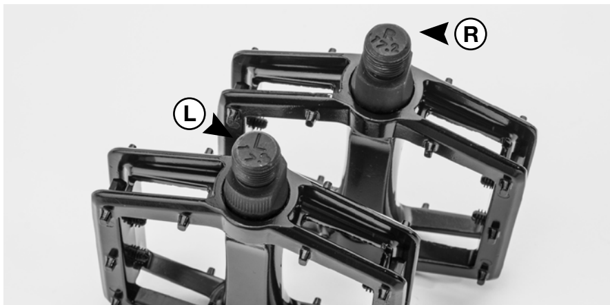
Diagrama 13. Marcas "R" (derecha) y "L" (izquierda).
