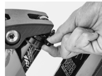
Figure 23. Maniement du bouchon de valve.
