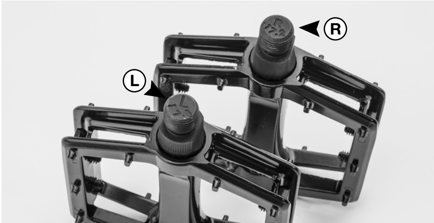
Figure 13. Marked «R» (Right) and «L» (Left).
