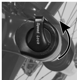
Figure 19. Molette en position ouverte.
