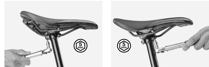
Abb. 9. Schrittweises Anziehen/Lösen der Klemmschrauben.
