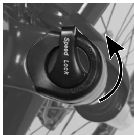
Diagrama 19. Palanca en posición abierta.
