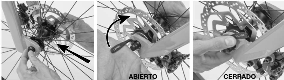
Diagrama 16. Etapas del apriete del eje.
