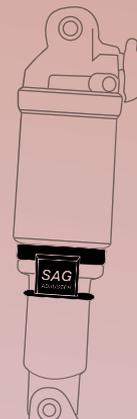
El clip de plástico con la etiqueta «SAG Adjuster» debe estar alineado con la junta tórica. Si la junta tórica queda por debajo, significa que tu amortiguador necesita más aire. Por el contrario, si la junta tórica queda por encima, hay demasiado aire en el amortiguador.
