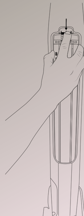
3. Sortez la batterie en pressant l'encoche supérieure et en tirant vers vous
