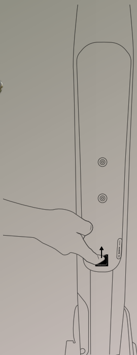
1. Retirez le capot de batterie
